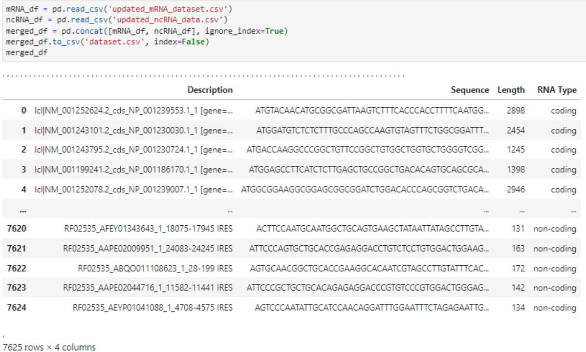
Figure 17. La fusion des deux datasets utilisant de la fonction concat()
